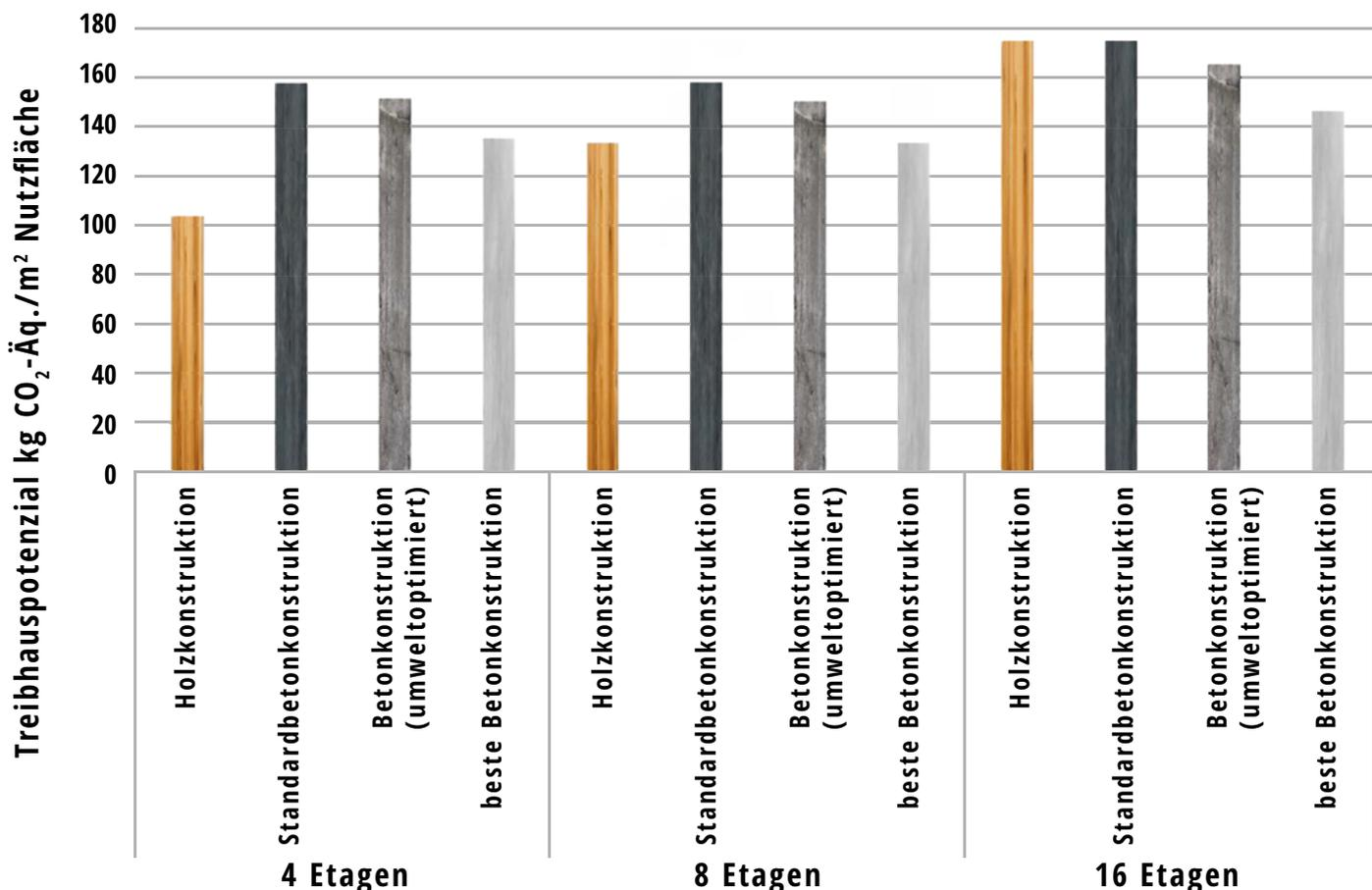
Mit einer im Hinblick auf die Umweltwirkungen optimierten Betonfertigteilkonstruktion lassen sich vor allem höhere Gebäude mit geringeren CO<sub>2</sub>-Emissionen realisieren als in Holzrahmenbauweise.
