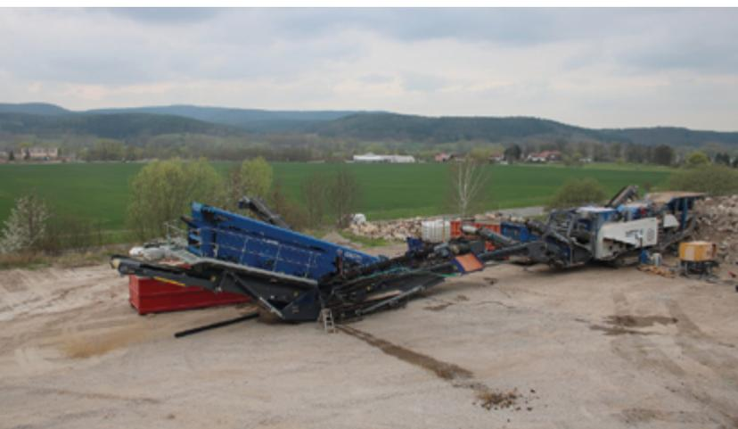
Mobile Bauschutttaufbereitungsanlage mit Brecher, Sortierung und Siebstation.
